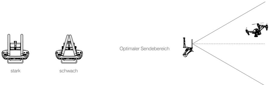
Halten Sie das Fluggerät stets im optimalen Sendebereich. Achten Sie auf den richtigen Sendewinkel und einen angemessenen Abstand zwischen Fernbedienung und Fluggerät.
